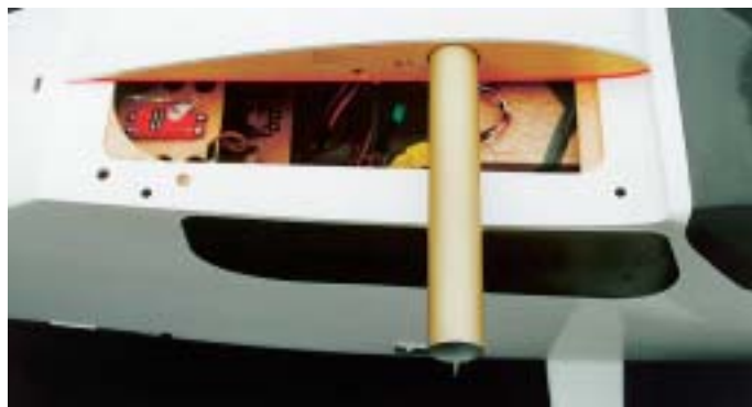
Stabile Sache: Tragflächenbefestigung und Flächenverbinder. Hinter der Endleiste ist der Schlitz für die Schleppkupplung zu sehen.
