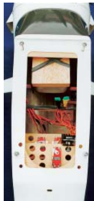
Der Tank wurde nur mit Gummis befestigt und durch einen Balsarahmen gegen Einziehen geschützt
